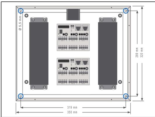
4. Befestigung: Bohren Sie, wie vorgegeben, am vorgesehenen Montageplatz vier Befestigungslöcher. Beachten Sie hierzu die Bohrmarkierungen in der Skizze und achten Sie auf entsprechende Untergrundfestigkeit sowie Hintergrundbelüftung des Gerätes. Alle Maße sind in Millimeter angegeben.
