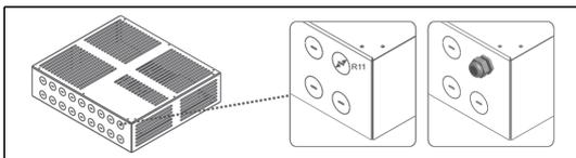
3. Herausbrechen der Kabelöffnung: Brechen Sie entsprechend den benötigten Leitungen die markierten Teile aus der Perforation heraus um Ihre Kabelverschraubung einzusetzen.
