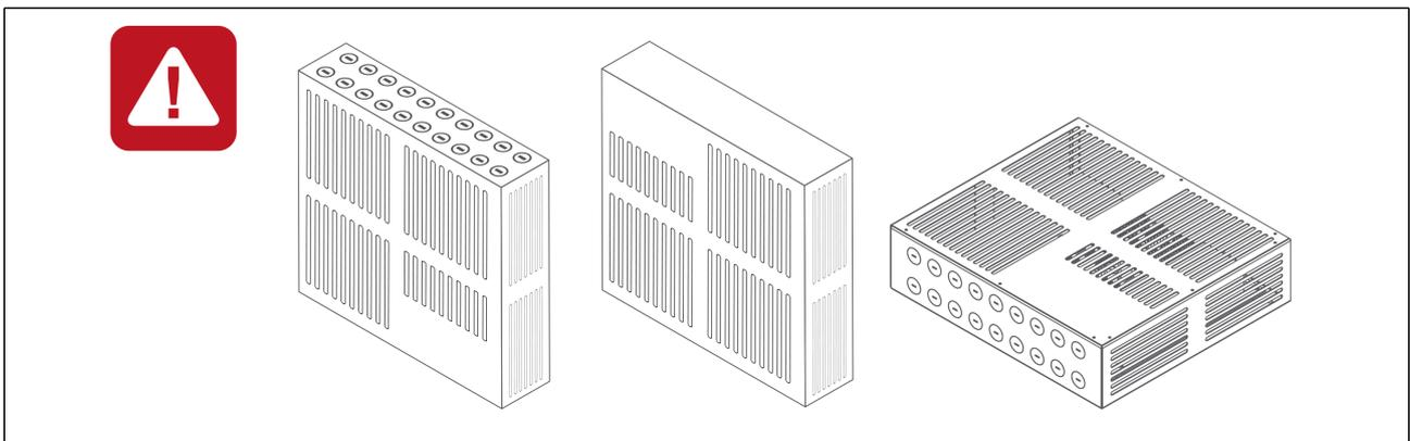
**ACHTUNG:** Gerät darf ausschließlich in diesen Positionen (siehe Skizze) montiert werden
